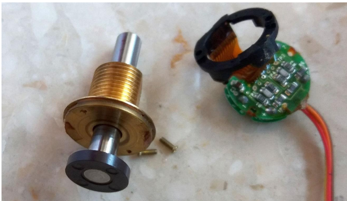
Rysunek 5. Enkoder z odkręconymi płytkami elektroniki. Oś z magnesem kołowym wysunięta z tulei mosiężnej. Obok 2 wkręty przykręcające podstawę płytek elektroniki.
